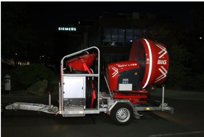
1 Mobiler Großraumlüfter (B.S. Belüftungs- GmbH, Bj. 2018)
