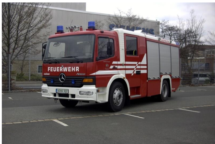
1 Löschgruppenfahrzeug LF 16/20 (MB/Rosenbauer, Bj. 2004)
